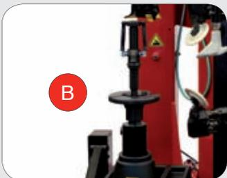
**IT** **SISTEMA DI BLOCCAGGIO RUOTA UNIVERSALE:** Sistema di bloccaggio manuale dotato di asta di fissaggio centrale rimovibile in grado di serrare cerchi da 12" a 30" senza regolazioni né adattatori. Accessori opzionali di serraggio sono disponibili per cerchi di forma non-standard.
