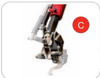
**IT** **UTENSILE AUTOMATIZZATO «LEVER-LESS»:** Utensile automatico completo di protezioni di plastica e gestito tramite apposito joystick di comando. Grazie ad una veloce e ripetitiva procedura di smontaggio ruota automatica, si annulla ogni rischio di danneggiare cerchione o pneumatico.
