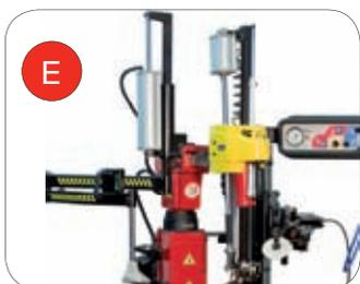
**IT** **DISPOSITIVO PREMITALLONE IPH:** Nuovo braccio pneumatico flottante fornito di serie per ruote ribassate o particolarmente difficili come le «Run-Flat». L'altezza dell'utensile di pressione è facilmente riducibile per operare efficacemente sui pneumatici con cerchi a canale rovescio.
