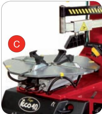
**IT** **SELF-CENTERING TURNTABLE:** Sistema con capacità di serraggio esterno da 11" a 24" per la TECO 40 TOP e da 11" a 26" per la TECO 42 TOP (con AR10 forniti standard). La speciale geometria del gruppo di serraggio griffe dotato di bielle curve permette di mantenere costante la forza di bloccaggio al variare del diametro del cerchio mentre il raccordo girevole in acciaio concorre a rinforzare tutta la struttura della macchina.
