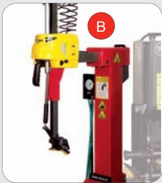
**IT** **PALO VERTICALE:** In configurazione extra-rigida, il palo è dotato di boccole coniche e triplo sistema di recupero giochi per facilitare le operazioni di manutenzione. La movimentazione pneumatica del braccio operante e il doppio sistema di bloccaggio completo di rullini di scorrimento del braccio orizzontale permettono di ottenere un migliore livello di precisione di lavoro.
