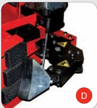
**IT** **SISTEMA DI STALLONATURA:** Braccio dotato di cilindro a doppio effetto ad alta efficienza ed equipaggiato con meccanismo brevettato che ottimizza l'operazione di stallonatura mantenendo costantemente l'inclinazione ottimale di lavoro tra paletta e fianco del pneumatico. Anche l'appoggio ruota è regolabile in 2 posizioni di lavoro.
