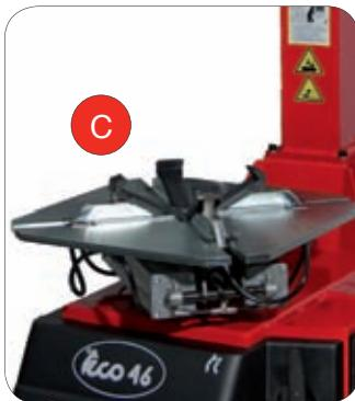
**IT** **PIATTO AUTOCENTRANTE:** Sistema che permette di serrare cerchi da 10" a 25" per la TECO 46 e da 11" a 27" per la TECO 48 senza regolazioni né adattatori. La speciale geometria del gruppo di serraggio griffe dotato di bielle curve permette di mantenere costante la forza di bloccaggio al variare del diametro del cerchio.
