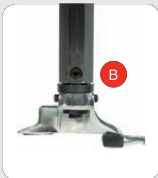
**IT** **SISTEMA DI CAMBIO RAPIDO TORRETTA:** Sistema brevettato di cambio rapido torretta integrato nell'asta verticale che permette un immediato cambio dell'utensile senza perdere l'originaria capacità di lavoro della macchina.
