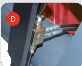
**IT** **DISPOSITIVI DI SICUREZZA:** Il TECO 55 A è dotato di numerosi dispositivi di sicurezza concepiti per garantire la salvaguardia dell'operatore: valvole di non-ritorno sul mandrino auto-centrante, interruttore magneto-termico a protezione del motore e dispositivo meccanico di bloccaggio del basculamento del braccio porta-utensili.
