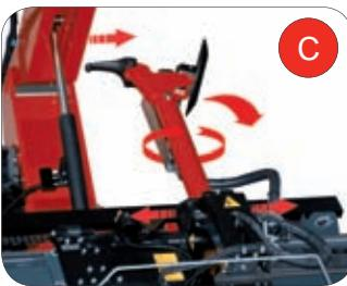
**IT** **LIVELLO DI AUTOMAZIONE:** Traslazione automatica a 2 velocità del carrello porta-utensili simultaneo al movimento automatico del mandrino. Sollevamento del braccio e rotazione degli utensili controllati automaticamente attraverso la centralina di comando. Funzione addizionale di traslazione automatica S-T-S.
