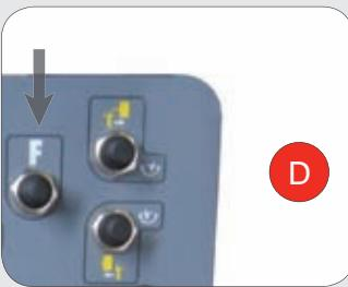
**IT** **FUNZIONE DI TRASLAZIONE AUTOMATICA S-T-S:** La funzione di traslazione «Side-To-Side», gestita attraverso l'apposita unità di comando, permette la movimentazione automatica diretta del gruppo porta-utensili da una parte all'altra della ruota. Rilevamento degli ingombri ruota tramite dispositivo Laser dedicato.
