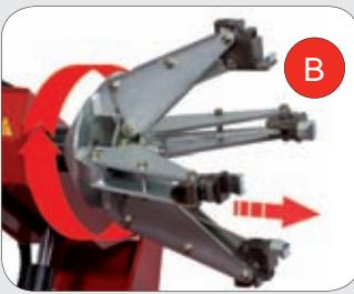
**IT** **MANDRINO AUTO-CENTRANTE:** Mandrino idraulico a 2 velocità di rotazione nei 2 sensi e traslazione automatica a 2 velocità simultanea alla traslazione del carrello porta-utensili. La capacità di serraggio da 14° a 44° può essere inoltre incrementata fino a 60° utilizzando il kit di prolunghe opzionale SE-580.
