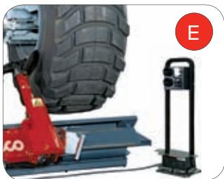
**IT** **CENTRALINA COMANDI:** La macchina è equipaggiata con una centralina comandi mobile a basso voltaggio che ne permette un ideale posizionamento all'interno dell'area di lavoro. La razionale disposizione dei comandi evita di indurre l'operatore in errore. Disponibile su richiesta un radiocomando a 16 frequenze programmabili.
