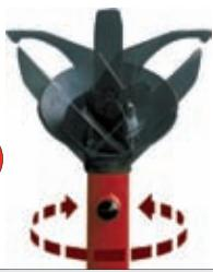
**IT** **BRACCIO PORTA-UTENSILI:** Sollevamento del braccio e rotazione degli utensili controllati automaticamente attraverso la centralina di comando. Lo speciale profilo semi-sferico del disco di stallonatura permette una più efficace penetrazione tra cerchio e pneumatico.
