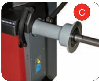
**IT** **SISTEMA DI LANCIO:** Sistema di lancio a cinghia a velocità variabile per ottenimento massima affidabilità e silenziosità di marcia ed ampia distanza (275mm) tra corpo macchina e piano di appoggio ruota, ideale per il serraggio di ruote Racing senza necessità di flange supplementari.
