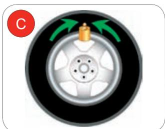
**IT** **RICERCA AUTOMATICA POSIZIONE DI EQUILBRATURA:** Sistema di lancio a cinghia a velocità variabile e bloccaggio elettronico dell'albero porta-ruota. Al termine del lancio, la macchina posiziona automaticamente la ruota nell'esatta posizione di applicazione del peso.
