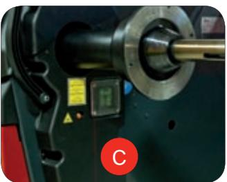
**IT** **RICERCA AUTOMATICA POSIZIONE DI EQUILIBRATURA:** Il ciclo di equilibratura viene attivato abbassando la protezione ruota. Al termine del lancio, la TECO 710 posiziona automaticamente la ruota nell'esatta posizione di applicazione del peso, sia per il fianco esterno che per quello interno.
